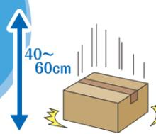
商品を一定の高さから落下させて、包材が破れないか、内容物が壊れないかなどを調べます。
