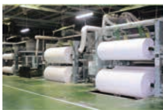
ジャンボロールを実際に使用するサイズへ巻き直す際に、芯穴を成形します
